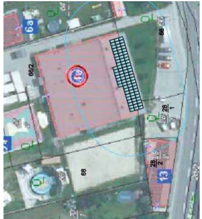
Photovoltaikanlage am Dach der Mehrzweckhalle
